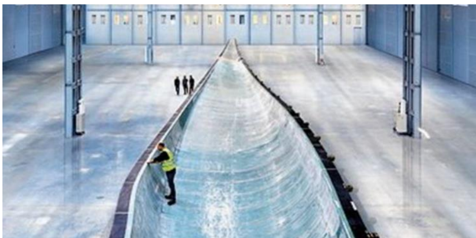
在 Siemens Gamesa 丹麦奥尔堡制造车间进行铺层时的叶片
