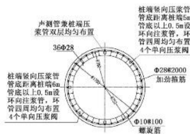
桩侧注浆器安装图
