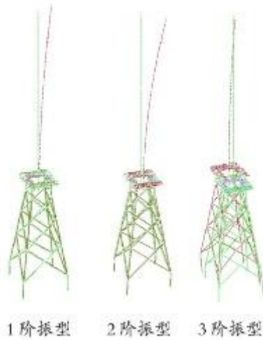
风电机组前三阶模态振型
